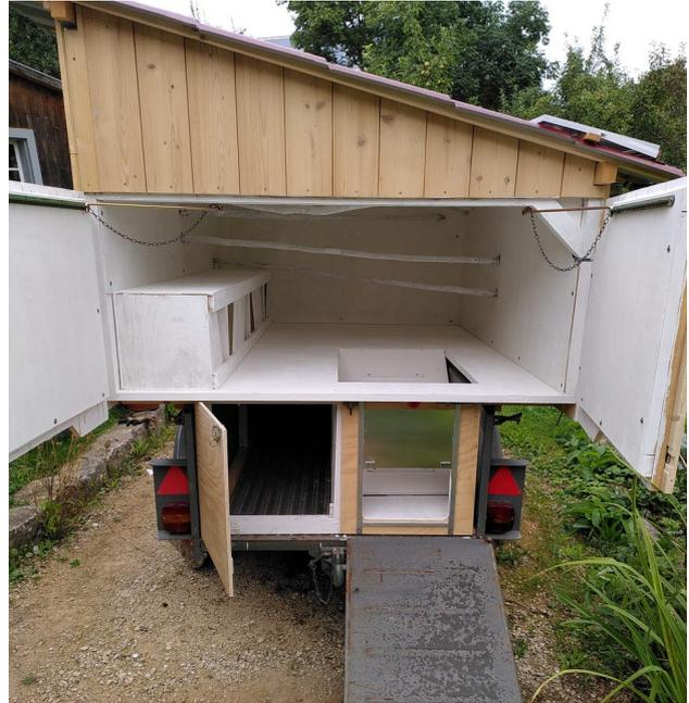
Es ist so gebaut, dass man unten Stauraum für Werkzeuge, Futter, Zaunmaterial und oder Heu hat (Bild rechts). Die Tür ist solarbetrieben und mit einer Zeitschaltuhr ausgestattet.
